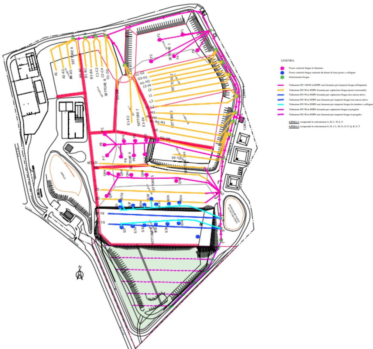
Figura 5 - rete captazione biogas
