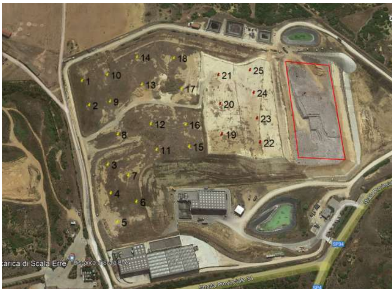
Fig. 1 - Disposizione dei 25 Punti di campionamento presso la discarica per rifiuti solidi urbani di Scala Erre (Sassari), in rosso il modulo attualmente in coltivazione
