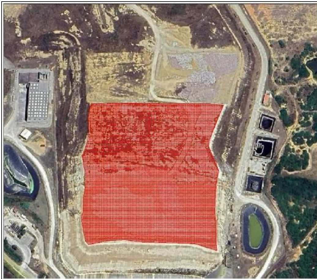
Figura 2B - Planimetria aree sopraelevazione sui moduli 3bis, 4, 5 e 6 per 55.000 m 3
