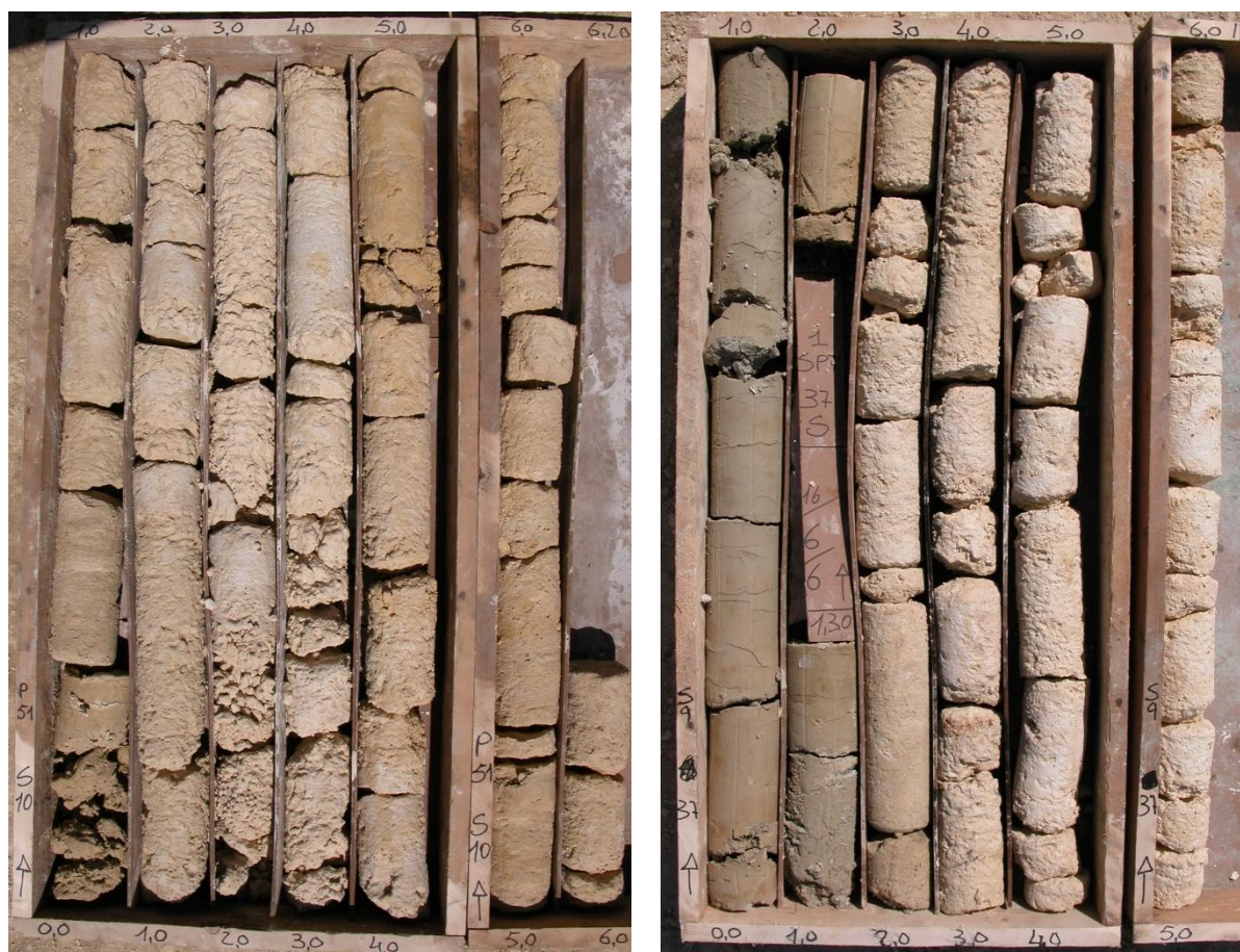
Foto 3 – Particolare di due sondaggi eseguiti nel cantiere di Via Mastino adiacente l'area d'intervento
