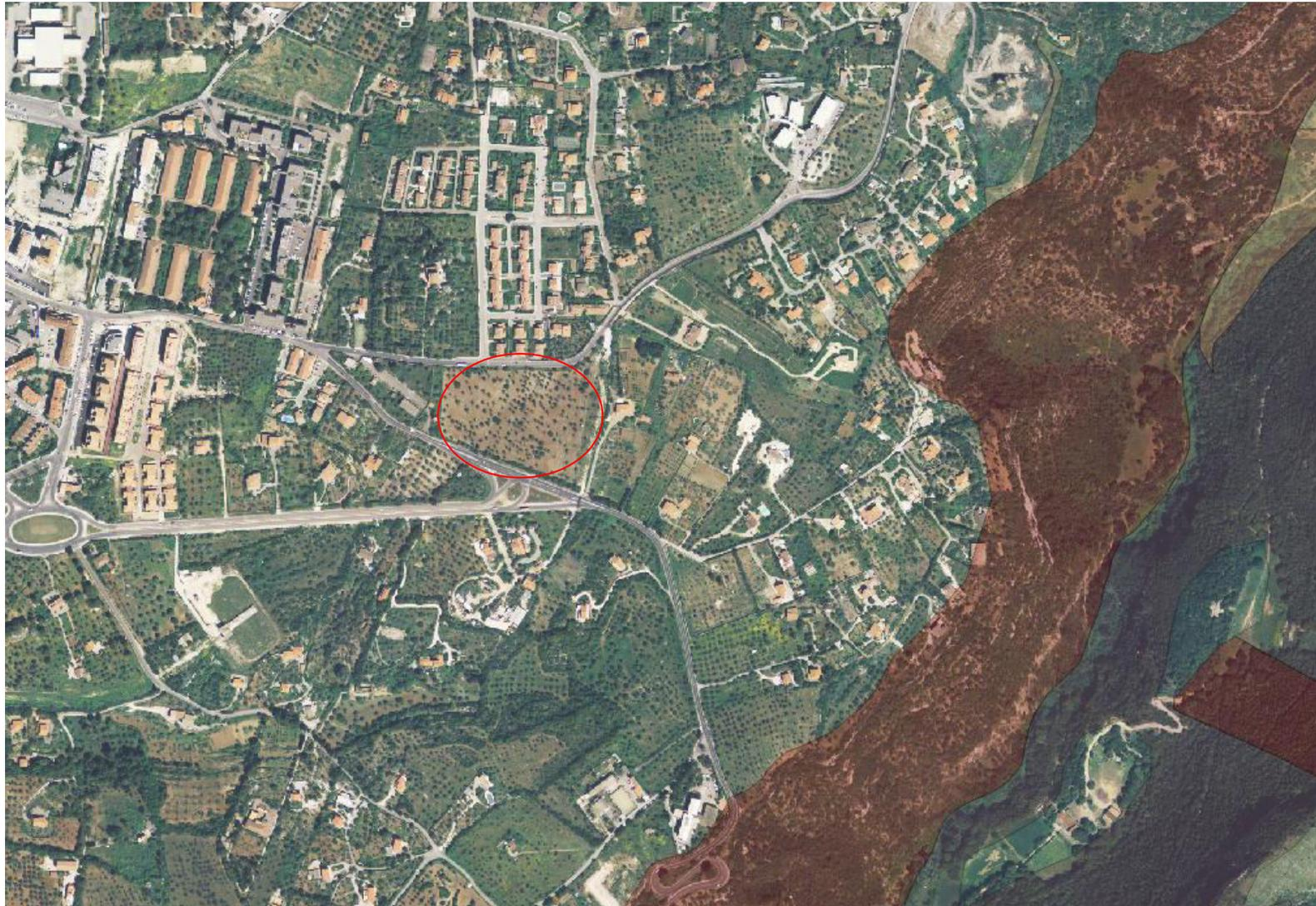
Figura 3: Rappresentazione aerofotogrammetrica con l'ubicazione dell'area di progetto e delle aree di pericolosità da frana individuate dal PAI.
