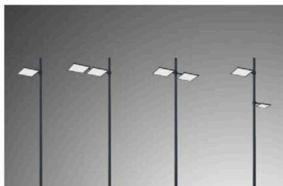
Per l'illuminazione delle strade verranno utilizzati corpi illuminanti su pali in metallo di colore grigio antracite, di altezza pari a 6/8 m, con 1 o 2 corpi illuminanti a LED di minimo ingombro per ogni palo posizionato su entrambi i lati della viabilità in corrispondenza dei marciapiedi; con tale soluzione si ottiene una illuminazione efficiente ma non invasiva che garantisce un contenimento dell'inquinamento luminoso.
