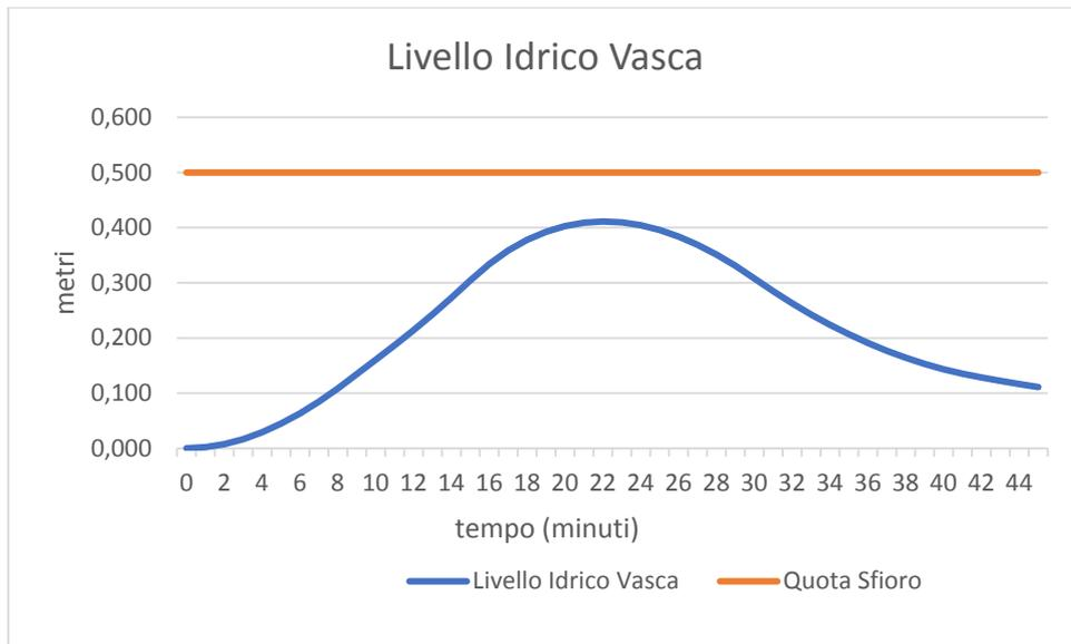
**Figura 11** - andamento livelli idrici nella vasca di accumulo
