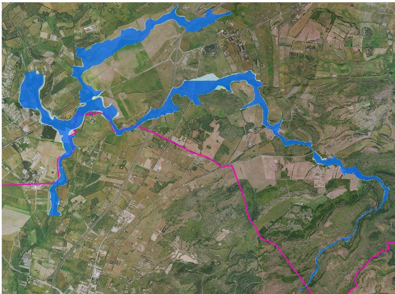
**Figura 233** - Aree a pericolosità idraulica del Rio Isipirida (affluente in sinistra del Rio Su Mattone)
