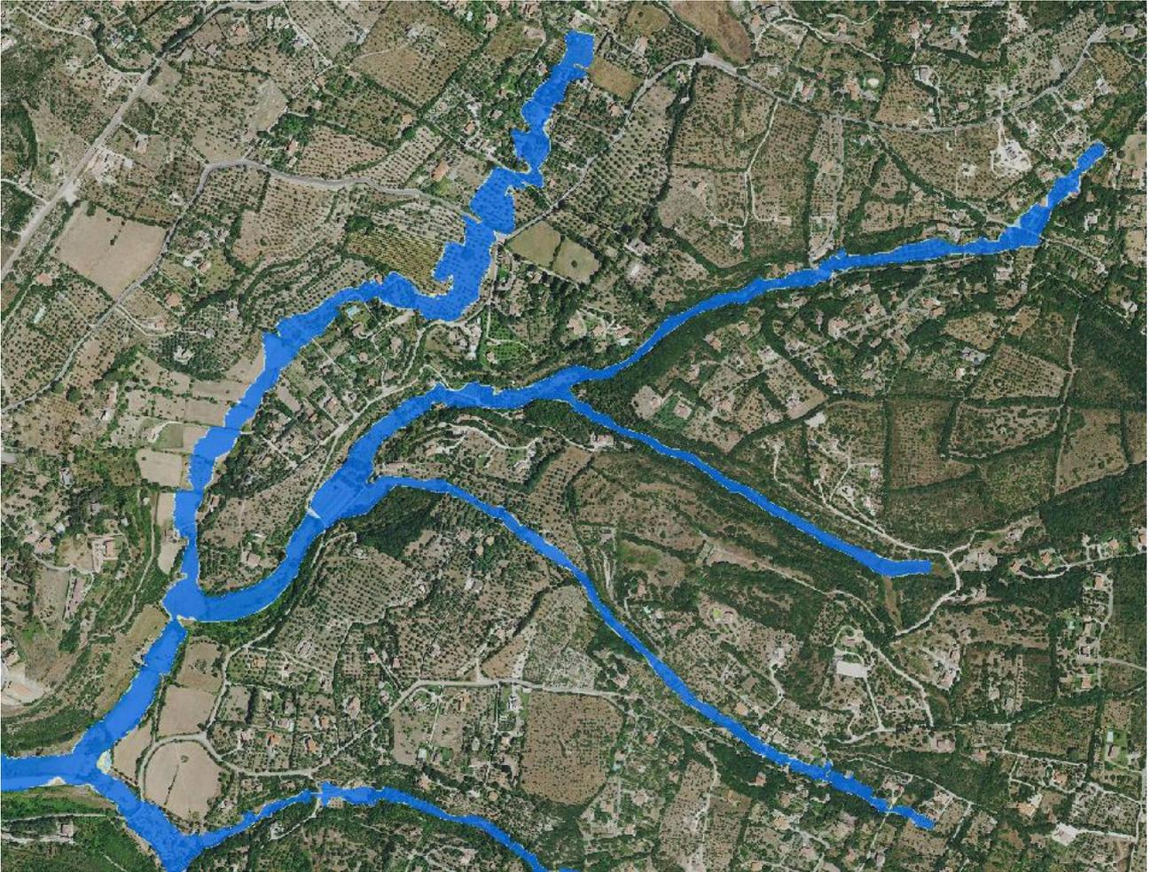
**Figura 17** – particolare delle aree di allagamento per il la zona di Monte Bianchinu – parte Nord
