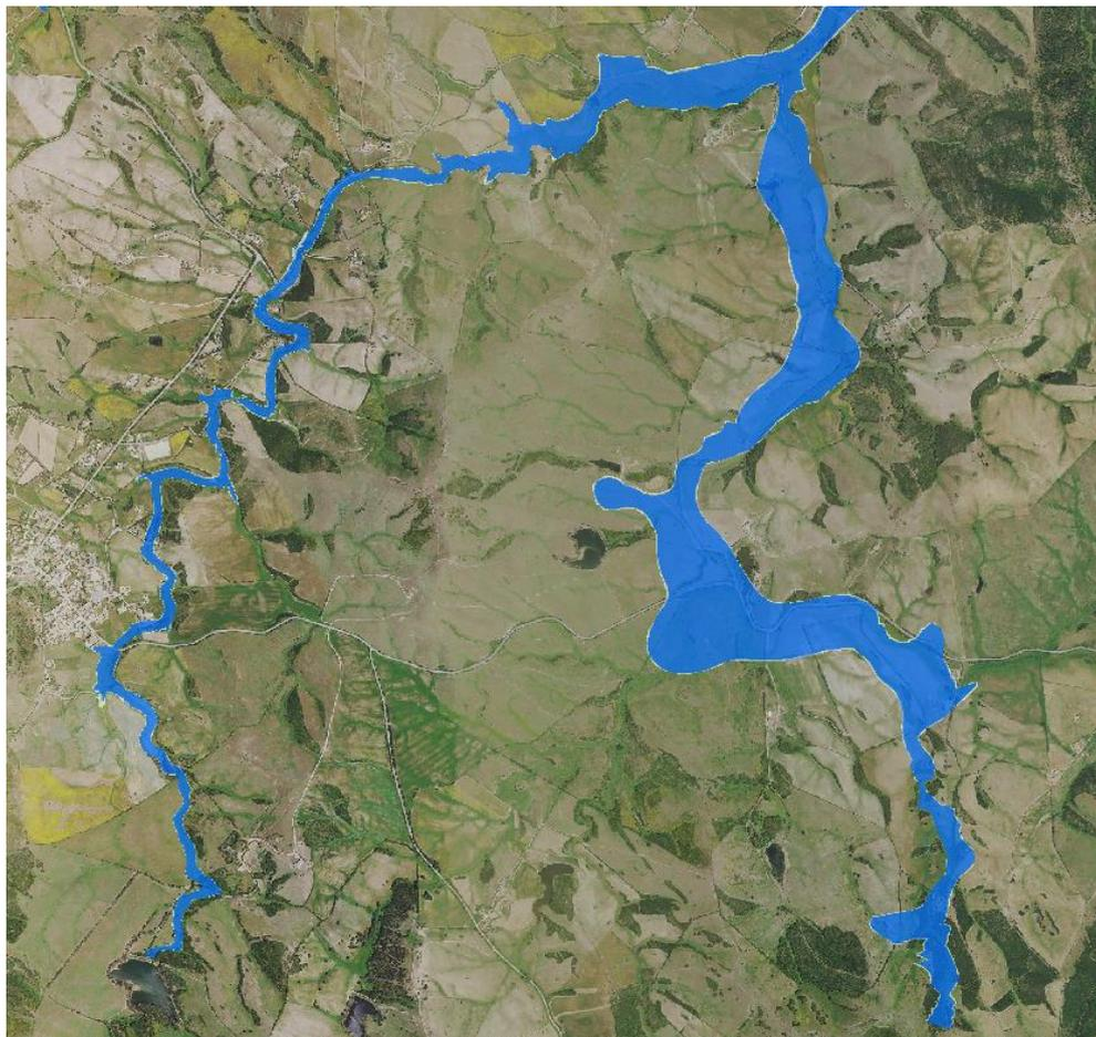
**Figura 204** - Aree di esondazione a pericolosità idraulica molto elevata, elevata, media e moderata, ottenute per ciascuno dei tempi di ritorno di 50, 100, 200 e 500 anni nel bacino del Fiume Santo - in evidenza anche il Rio d'Astimini
