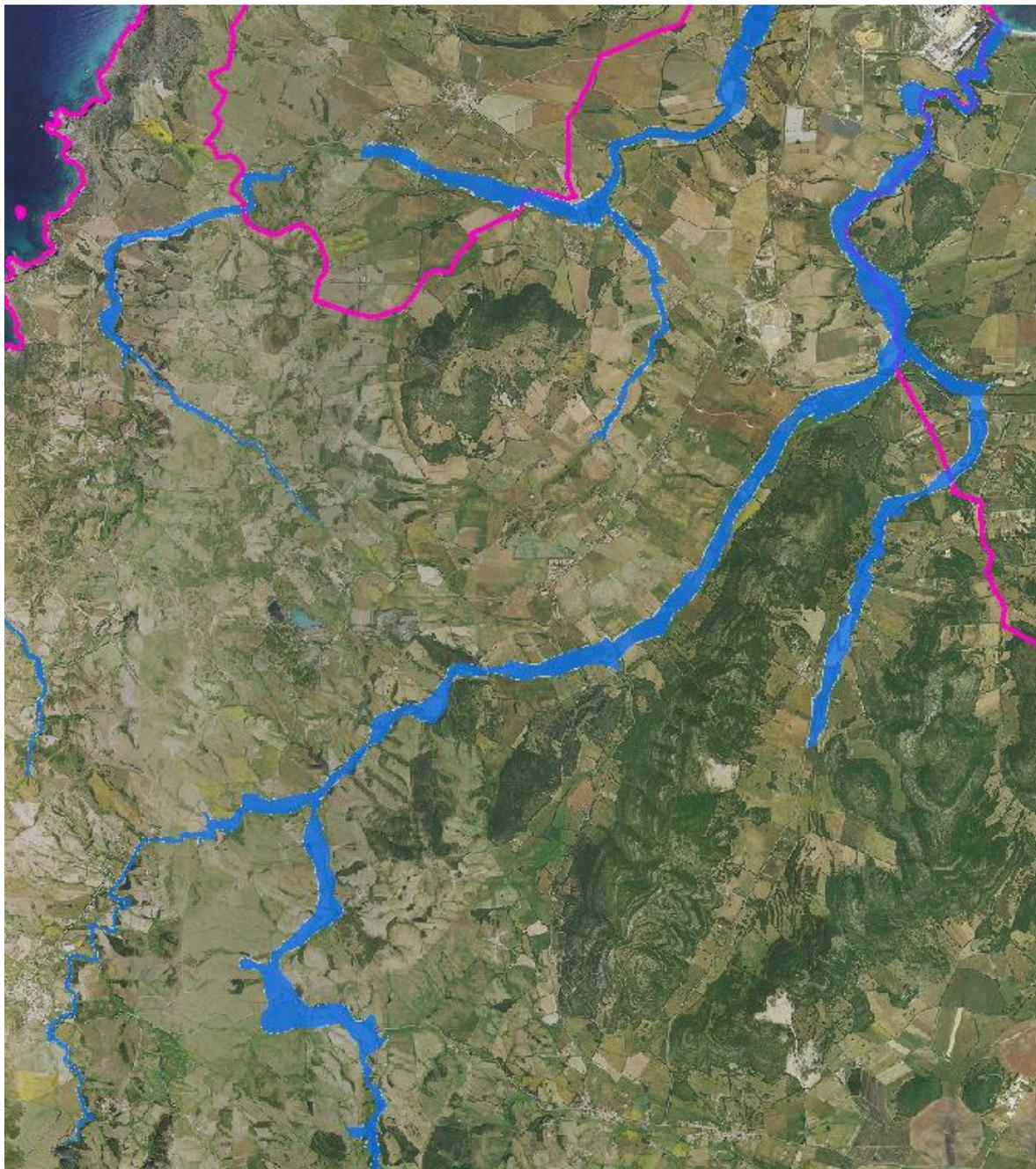
**Figura 203** - Aree di esondazione a pericolosità idraulica molto elevata, elevata, media e moderata, ottenute per ciascuno dei tempi di ritorno di 50, 100, 200 e 500 anni nel bacino del Fiume Santo.
